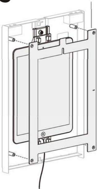
Fissare il pannello alla custodia utilizzando quattro viti (H). Prima di serrare completamente le viti, regolare le due griffe per tenere il tablet e garantire che lo schermo sia allineato e visibile attraverso il pannello frontale.
